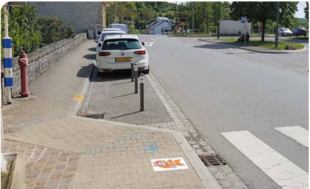
Manternach, gare : suppression d'un parking, 5m distance de sécurité au passage pour piétons.
