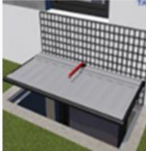
Flutschott (Quelle: [www.tas-hochwasserschutz.de](http://www.tas-hochwasserschutz.de))
